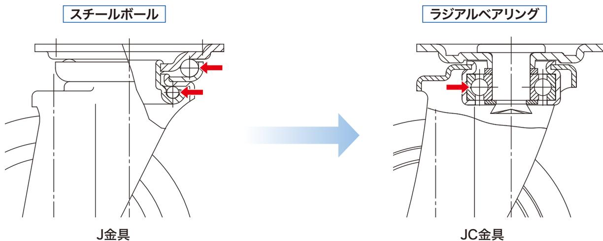
車輪に従来のコマーシャルベアリングに代えて、ラジアルベアリングを使用
